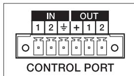
Der CONTROL PORT enthält zwei frei-programmierbare Steuereingänge und Steuerausgänge, sowie die Referenzanschlüsse für Masse und +5V. Die Steuereingänge sind mit Hilfe der PC Windows Software IRIS konfigurierbar, und dienen z. B. zur Power On / Standby Umschaltung, zur Presetumschaltung oder zur Parameterkontrolle.
